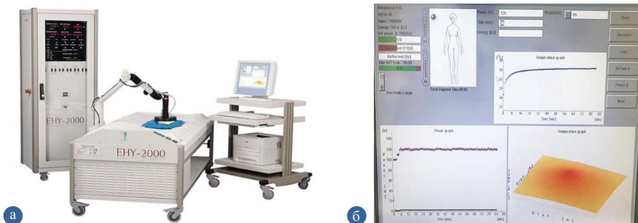
Рис. 2. Аппарат для проведения модулированной электрогипертермии (онкотермии) EHY-2000 (а) и пример динамического графического контроля параметров воздействия (б)
